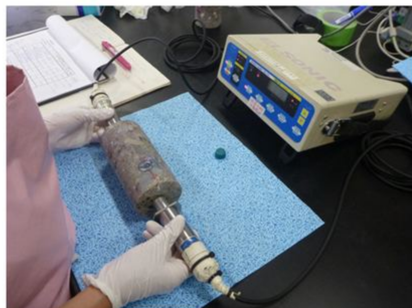
供試体による超音波法の様子
