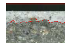
試験体での含浸深さの確認
