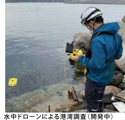
水中ドローンによる港湾調査（開発中）
